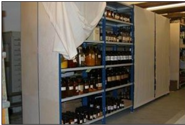
Fig. 11. Eksempel på reoler med lærredsforhæng til beskyttelse mod støvfald.
