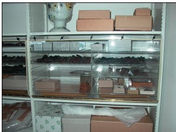
Fig. 19. Klimakasse reguleret med silicagel til bevaring af arkæologiske jerngenstande.
