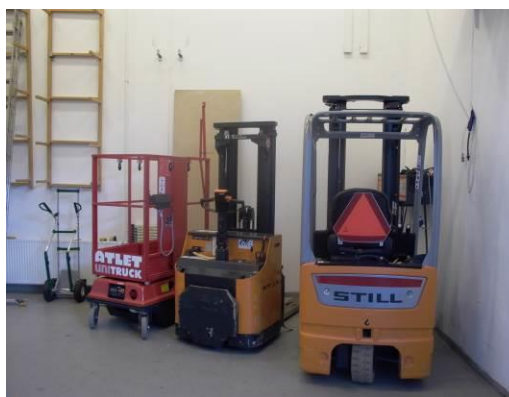
Figur 6: Fra venstre: Teleskoplift, el-pallestabileren og el-truck ved ladestationen i portrum
